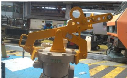
Pince pour levage de sécheur d'air -
